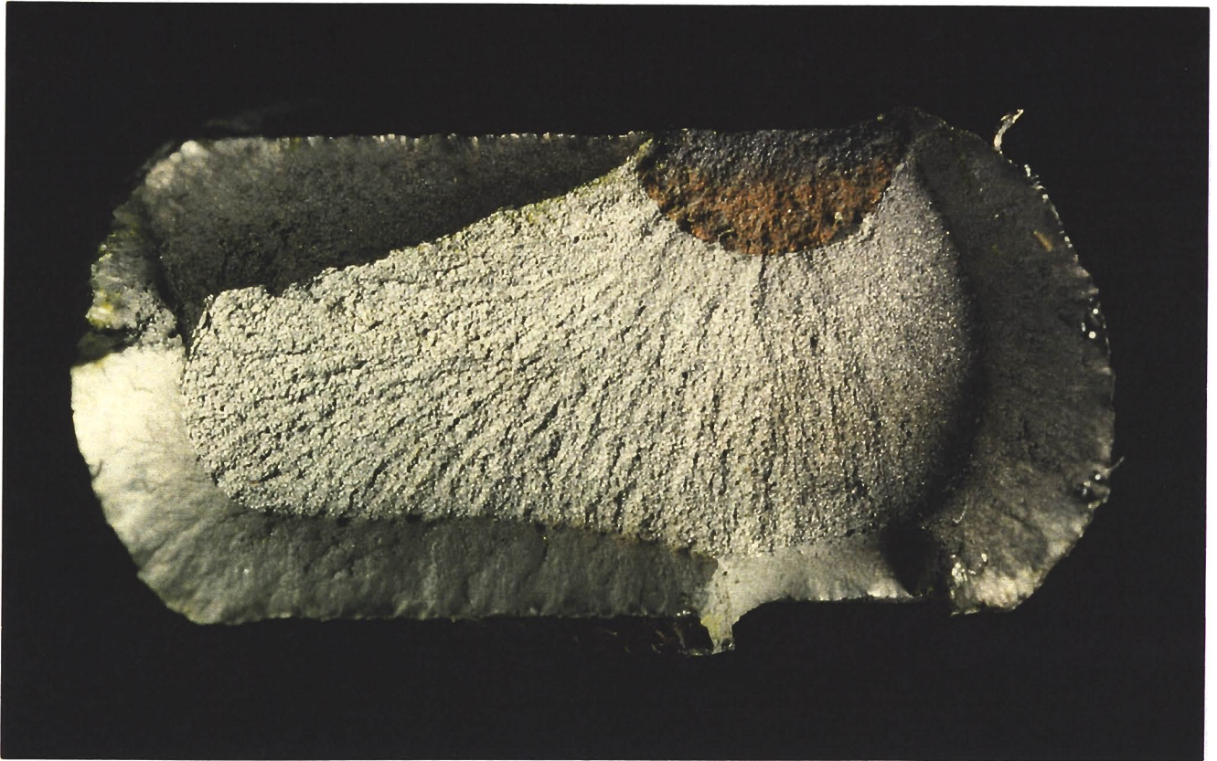
Abb. 34: Durch Zugversuch erzeugte Bruchfläche mit Anriß, der mittels Magnetpulverprüfung detektiert wurde, Kondenswasserbelastung (Probe: NEPWIT-R 2)
