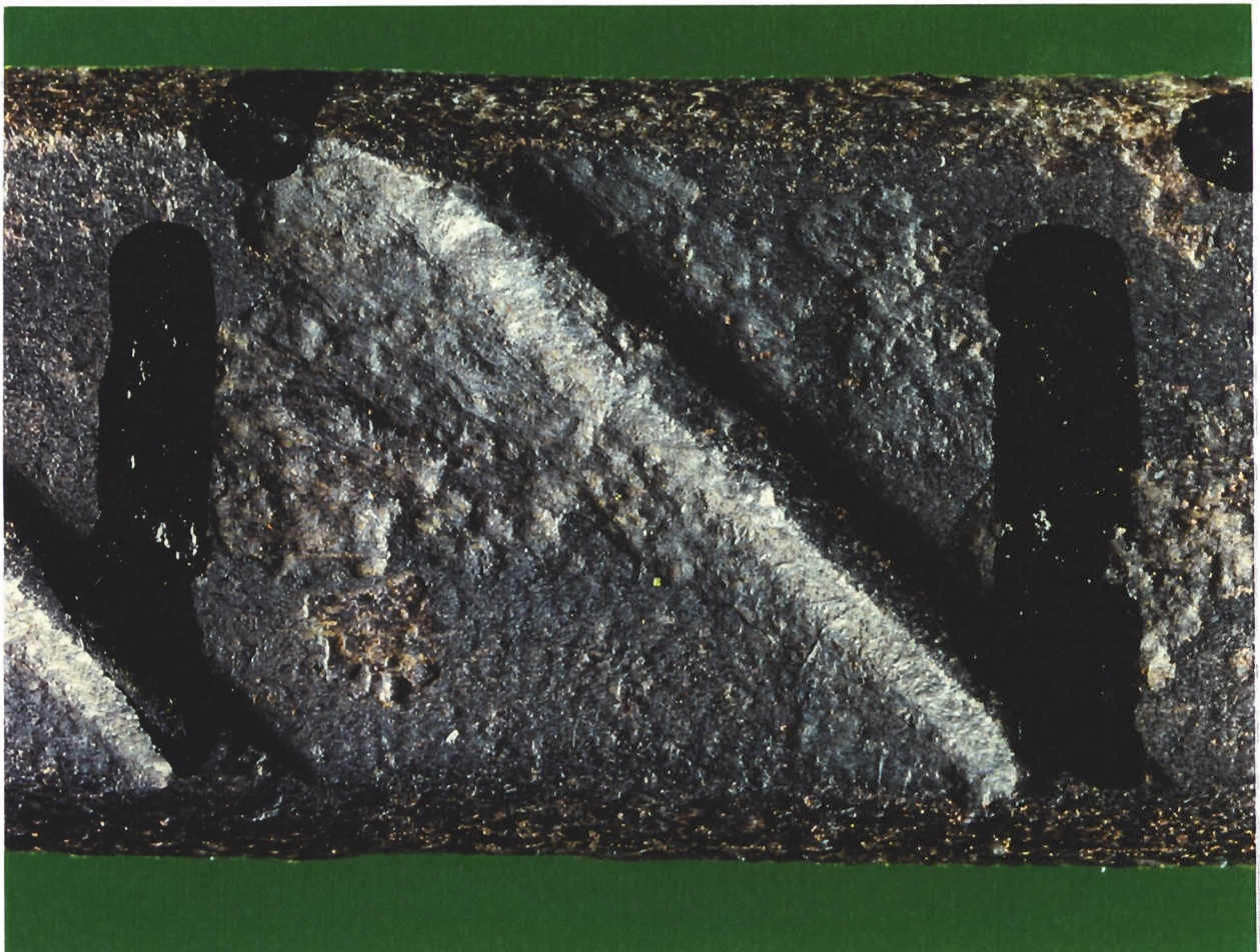
Abb. 36: Nach dem Beizen erkennbare Korrosionsnarben (Probe: NEPWIT 1)
