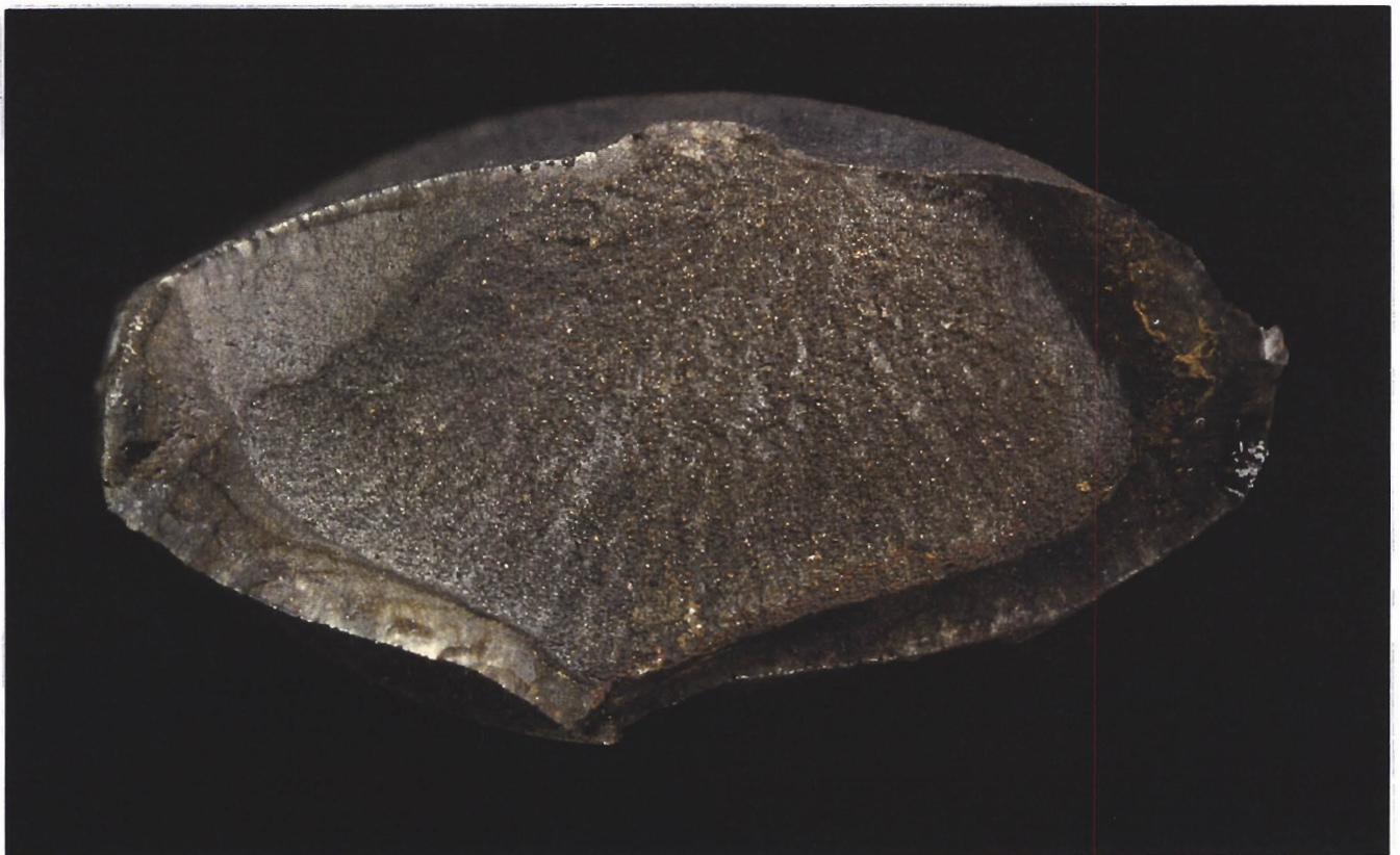
Abb. 20: Bruchfläche nach der Prüfung in der DIBt-Lösung (Probe: HENNEU 2)
