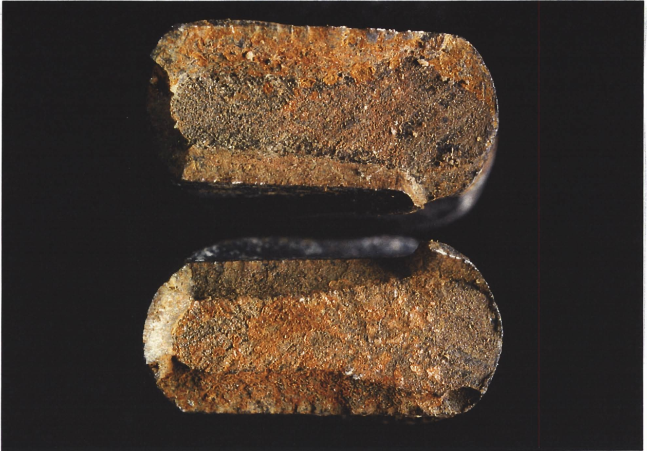
Abb. 21: Bruchfläche nach der Prüfung in der DIBt-Lösung (Probe: NEPWIT 2)
