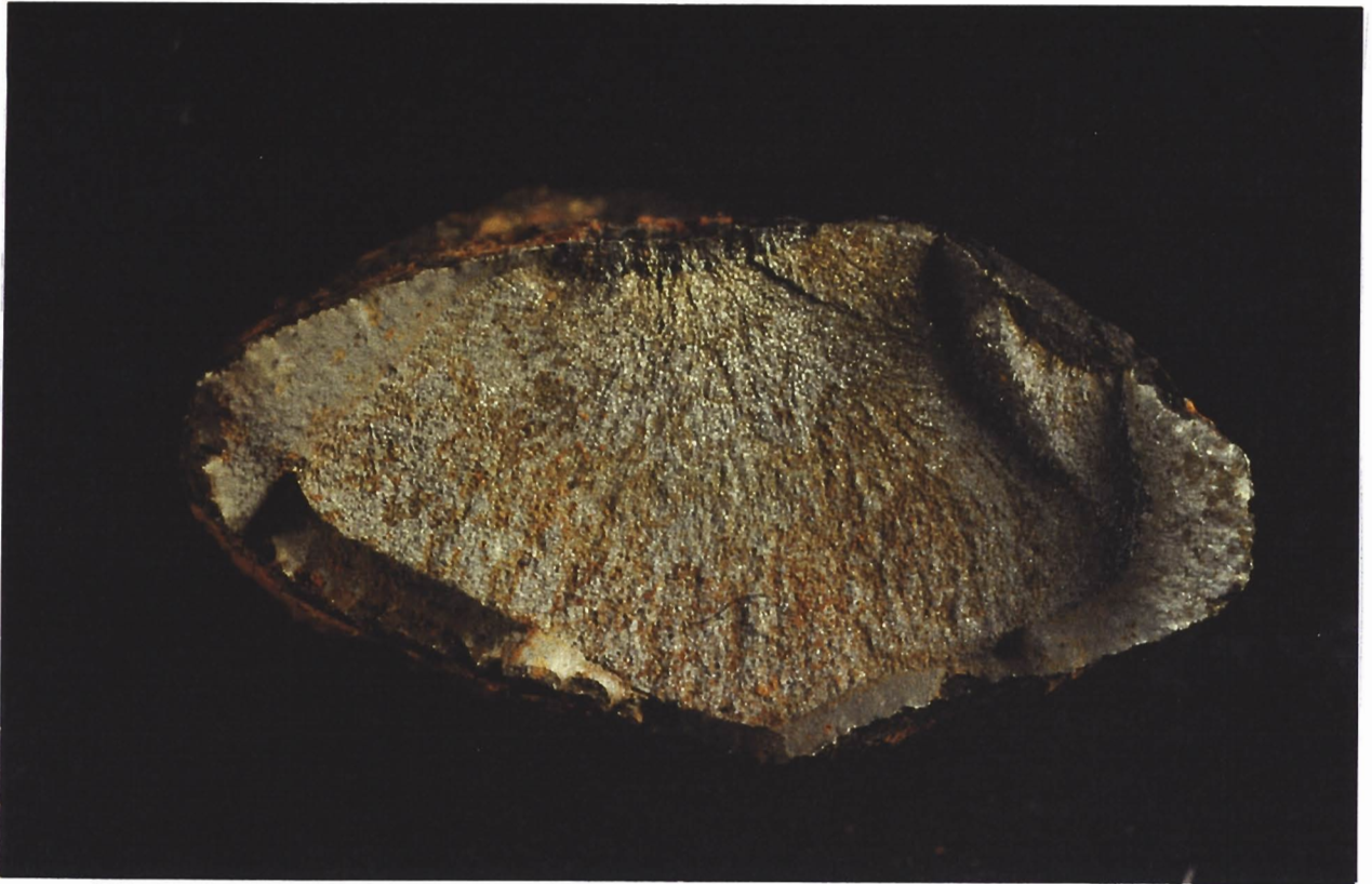
Abb. 37: Bruchfläche nach der Prüfung unter Kondenswasserbelastung (Probe: HENNEU S2)
