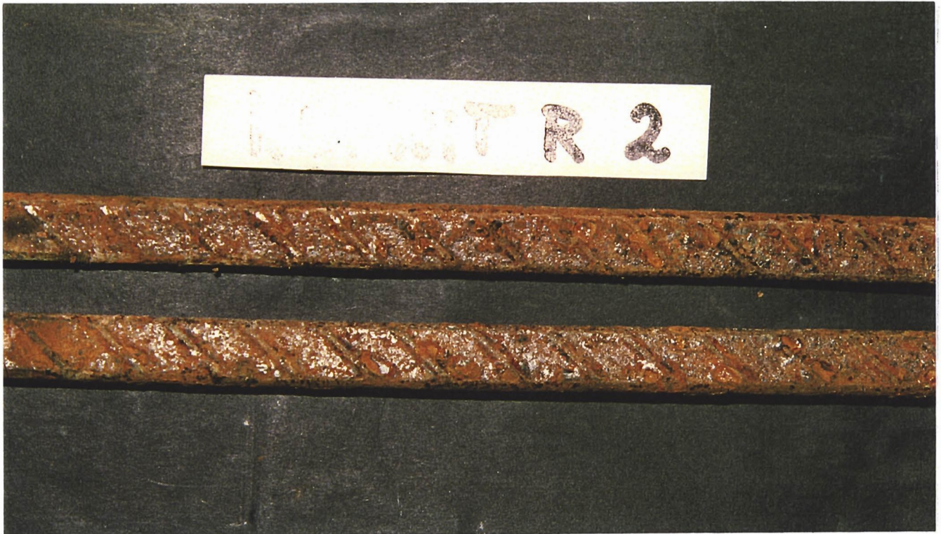
Abb. 35: Typisches Aussehen der Drahtoberfläche nach der Prüfung unter Kondenswasserbelastung (Probe: NEPWIT R 2)
